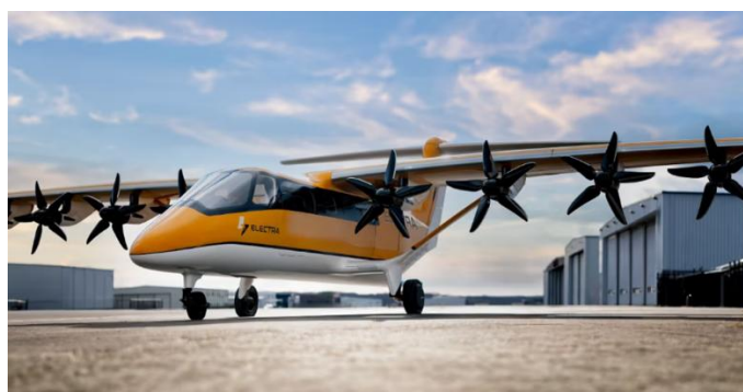
図 2.4.1.2-12 Electra Aero EL-9 Ultra-STOL (Electra Aero 社 HP)
