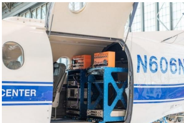
図 2.4.4.1-1 NASA Pilatus PC-12 の後部に搭載された実験用通信機器 ©NASA
