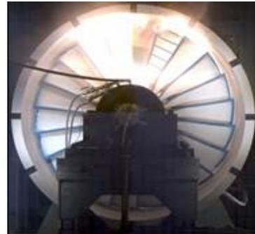
図 8 CFRP ファンケース FBO 試験<sup>1)</sup>
