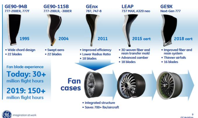
図2 GE社におけるCFRPファンブレード・ファンケースの開発<sup>2)</sup>
