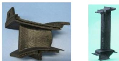
図 13 IHI における CMC タービン部品開発例 (左：静翼、右：動翼) <sup>5)</sup>
