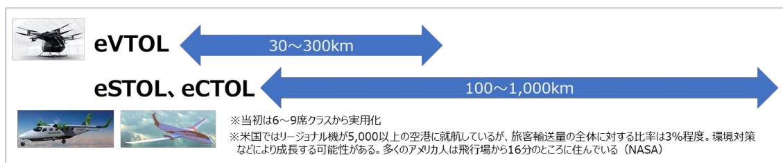
図 2.4.3-3 eVTOL、e-Aircraft (eSTOL/eCTOL) 機の運航レンジの考え方の例 (5)
