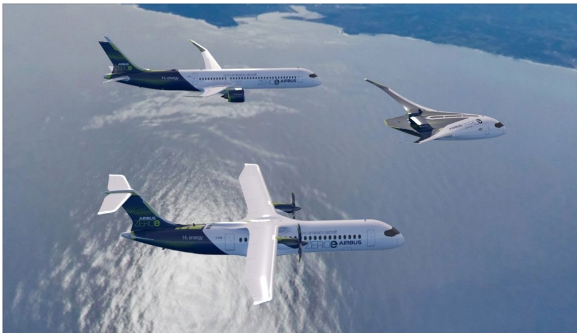
図 2 エアバス社の発表した水素燃料航空機 ZEROe プロジェクト・コンセプト機体 3)
