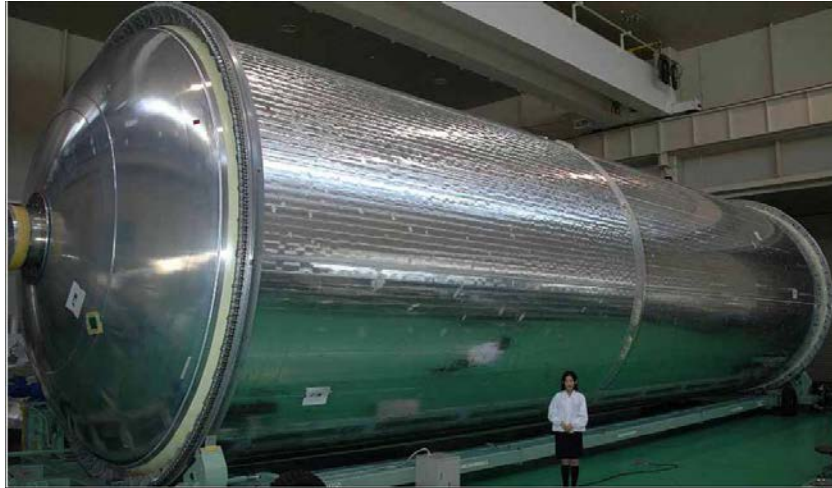
図 3. 1-2 H-II B ロケット推進薬タンクへの FSW 適用例 2)
