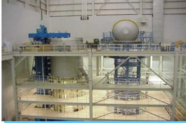
図3. 2-1 Delta IV 燃料タンク接合に用いた縦型 FSW 装置 1)
